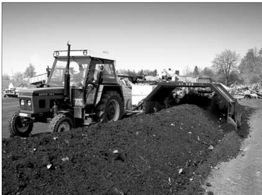
Příklad kompostování v pásových hromadách - překopávač kompostu zajistí jeho provzdušnění a promíchání
