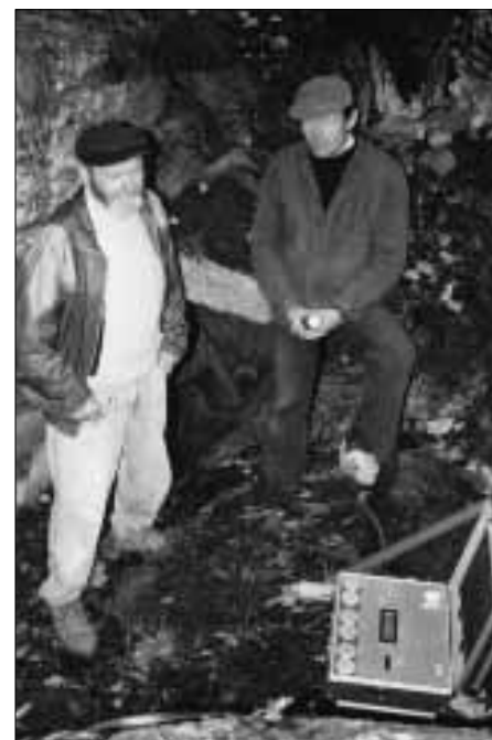
Měření objemové aktivity radonu pomocí přístroje LUK - 3A
